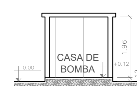
CORTE CC - CASA DE BOMBA ADM ESCALA 1:75
