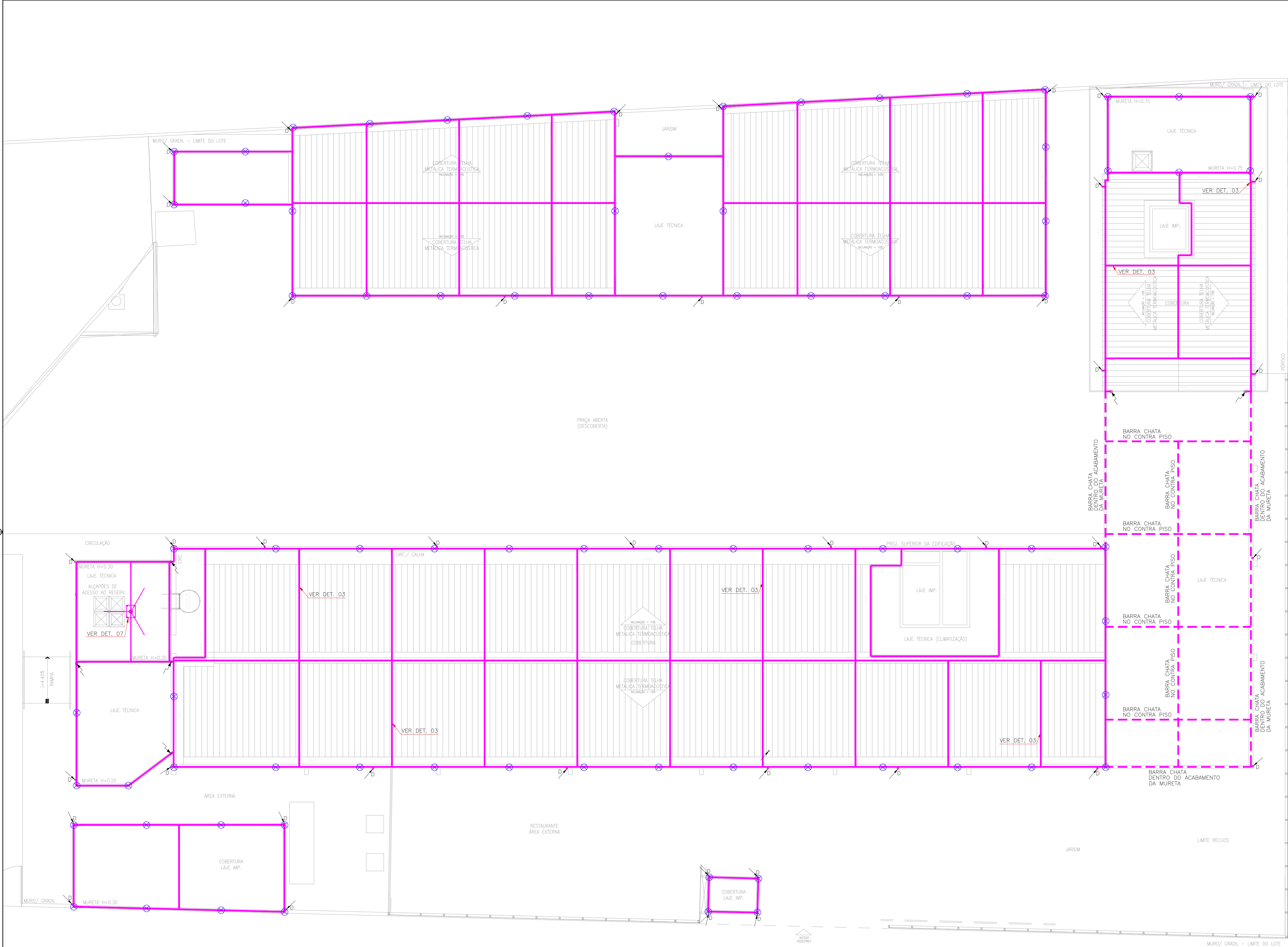
01 PLANTA BAIXA COBERTURA SPDA - CAPTAÇÃO E EQUALIZAÇÃO DE POTENCIAIS ESCALA: 1/100
